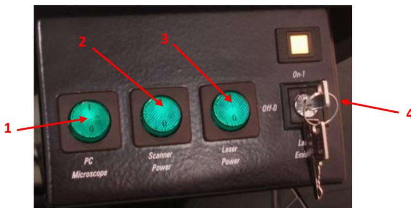
1. Mettre en marche la station de travail (bouton vert *PC Microscope*) : le système d'exploitation démarre automatiquement. Le microscope, la platine motorisée XY et l'écran du PC s'allument.
