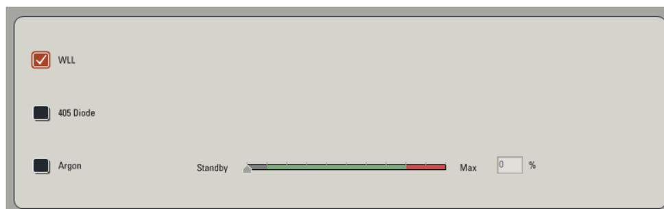
**Le laser Blanc (White Light Laser)** est un laser pulsé picoseconde (<0,5 W), la clé sur le boîtier d'alimentation doit toujours être sur ON (ne pas toucher le boîtier à gauche du statif). L'étalement spectral vient d'effets d'optique non linéaire dans le passage du faisceau pulsé dans une fibre spéciale induisant un super-continuum dont on utilise qu'une partie dans le spectre visible (470-670 nm) (d'autres détails en Annexe B1)
