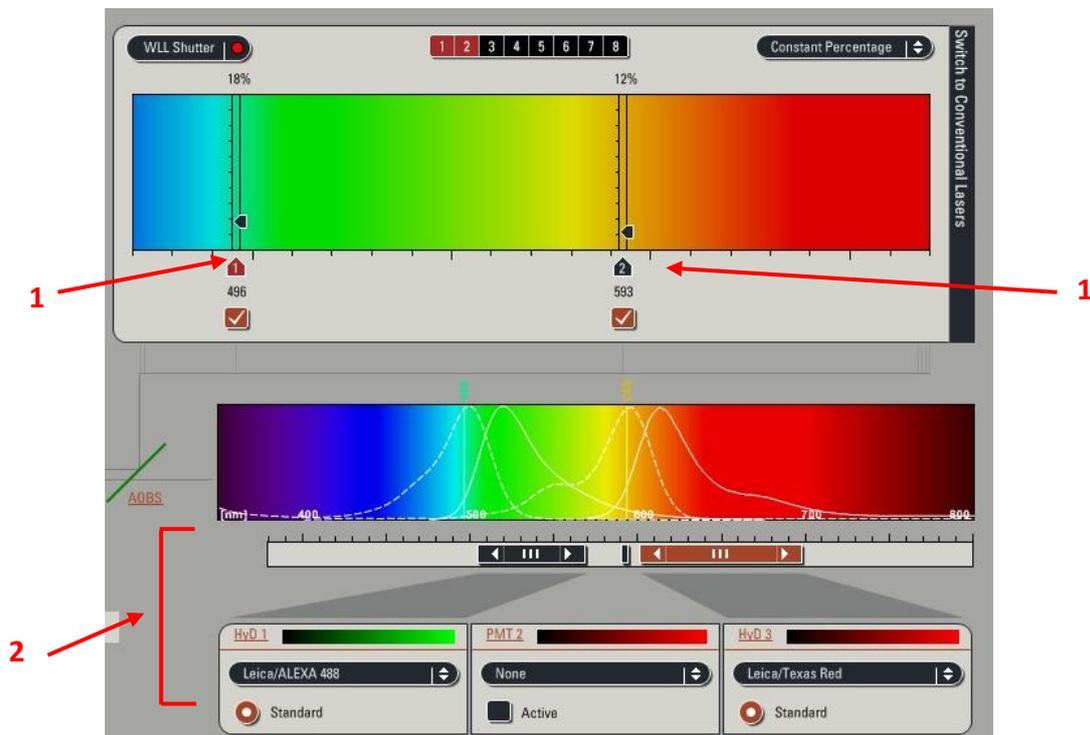
2. Pour chacun des détecteurs, ajuster le gain (et l'offset pour le PMT2) de manière à obtenir quelques pixels bleus (saturation) sur la zone d'intérêt de l'image et des pixels verts à l'extérieur de votre échantillon (absence de signal). Ajuster les fentes spectrales de manière optimales.
